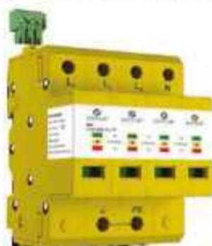
Lo ZotupLimiter L 2/10 230 t ff 4 TT, codice 212 240, è uno scaricatore di sovratensioni tetrapolare assemblato con quattro SPD a limitazione per circuiti trifase con neutro a 230/400 V, è ideale invece per l'installazione in sistemi TT a valle dell'interruttore differenziale RCD
