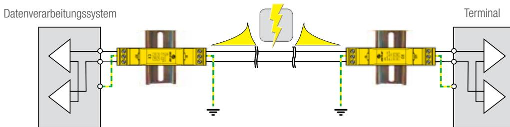
**S-AS 2 ist ein SPD, das in die Telekommunikations- oder Signalleitung eingeschliffen wird um empfindliche Geräte mit einer geringen Störfestigkeit zu schützen. Es bietet die folgenden besonderen Merkmale:**
