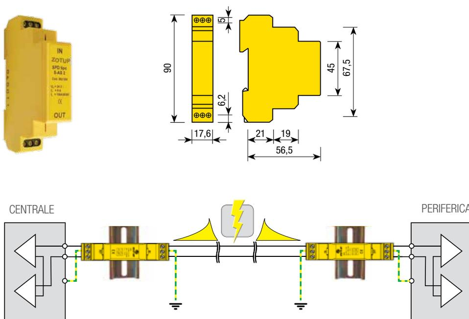
**S-AS 2 è un limitatore di sovratensioni SPD. Tipicamente installato in serie a circuiti di segnale di apparecchiature a basso livello di "resistibilità". Fornisce le seguenti caratteristiche e vantaggi:**
